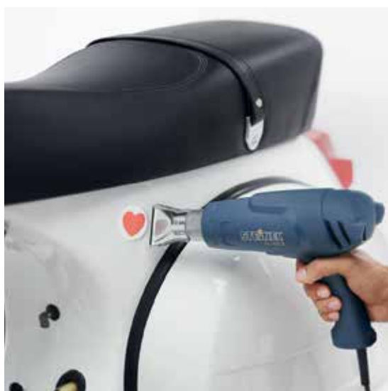
Удаление. Наклейка легко удаляется с помощью горячего воздуха
