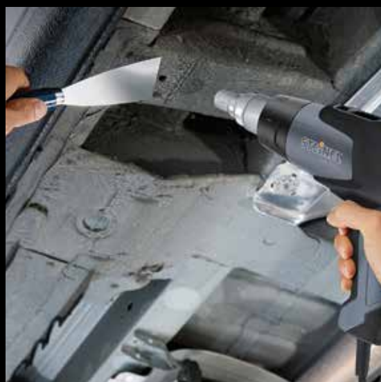
Удаление антикоррозийного покрытия кузова
