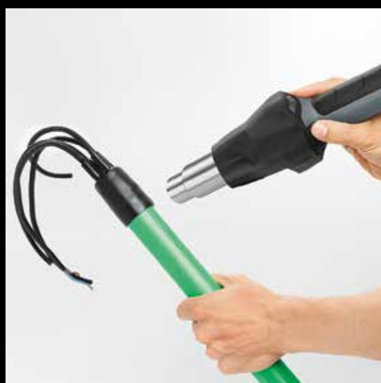
Промышленная термоусадка проводов
