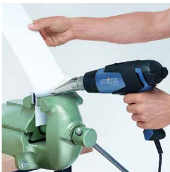
Придание желаемой формы пластику с помощью нагрева
