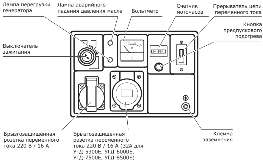
Рис. 2. Схема панели управления генераторов УГД-3000Е, УГД-4500Е, УГД-5300Е, УГД-6000Е, УГД-7500Е, УГД-8500Е.
