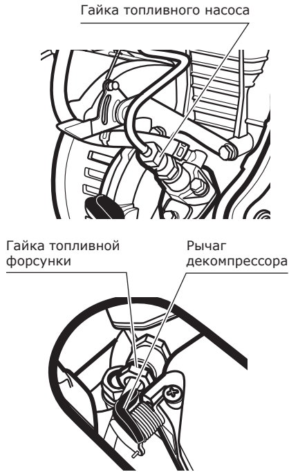
Рис. 16 . Удаление воздуха из топливной системы двигателя
