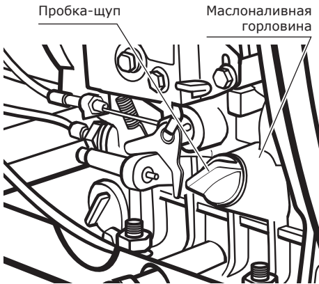
Рис. 11. Заполнение масляного картера и контроль уровня масла
