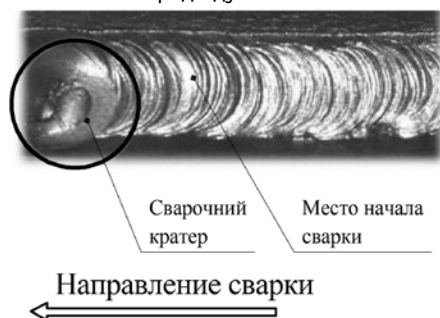
Рис. 9.2. Начало сварки при смене электрода.
