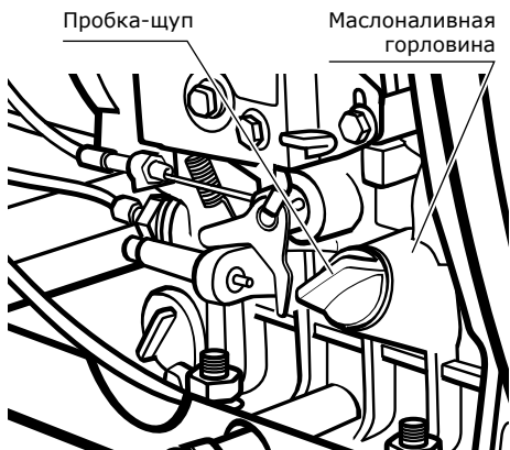
Рис. 9. Заполнение масляного картера и контроль уровня масла
