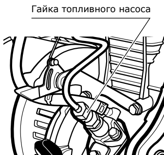
Рис. 14 . Удаление воздуха из топливной системы двигателя
