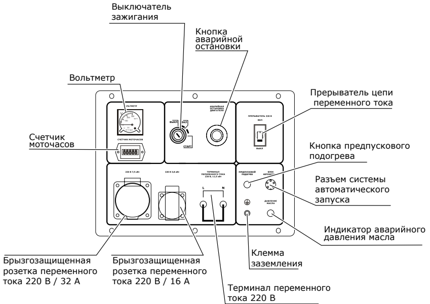
Рис. 6. Схема панели управления генераторов УГД-11500ЕТ и УГД-15000ЕТ
