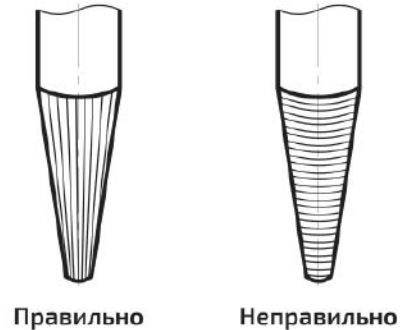
Рис. 9.5.3. Угол заточки вольфрамового электрода в зависимости от силы тока.
