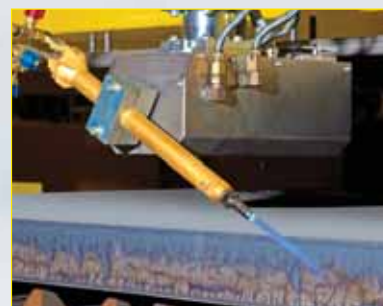
Кислородная резка со скосом кромок одной горелкой
