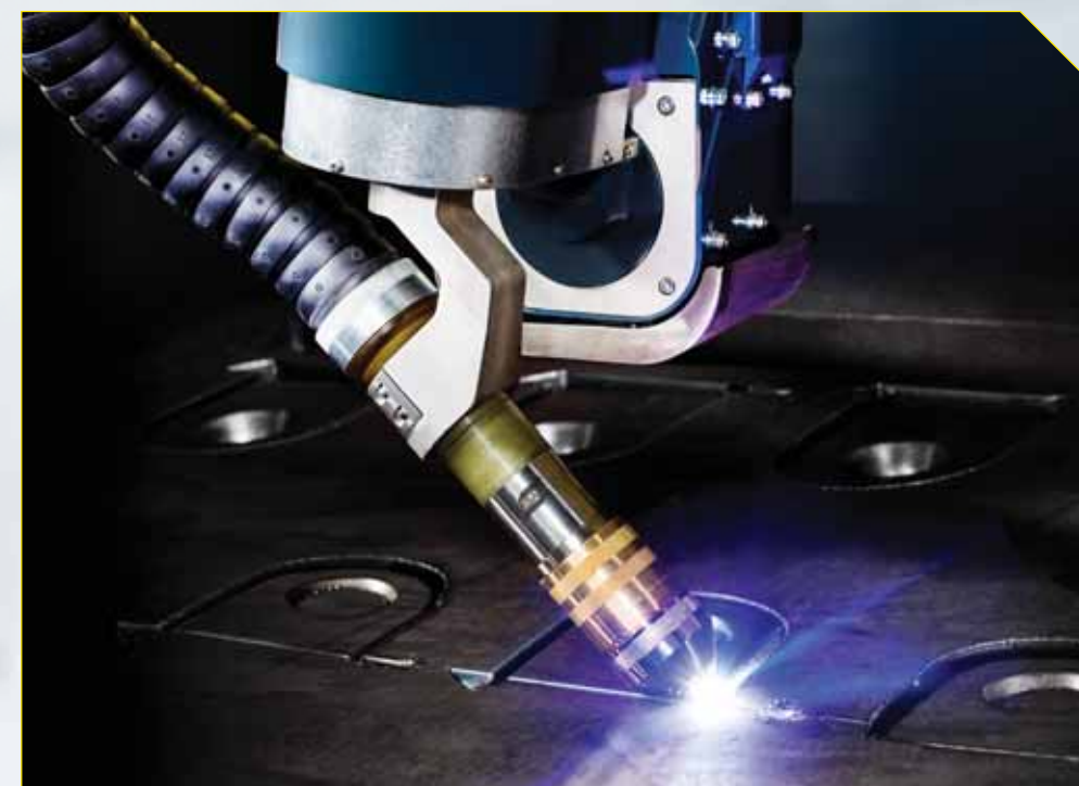
Плазменная резка со скосом кромок
