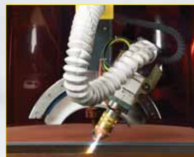
Высокоточная плазменная резка со скосом кромок
