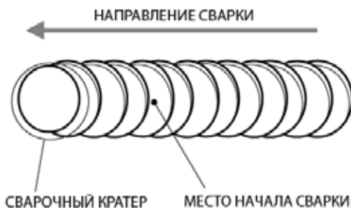
Рис. 13.5. Начало сварки при смене электрода.
