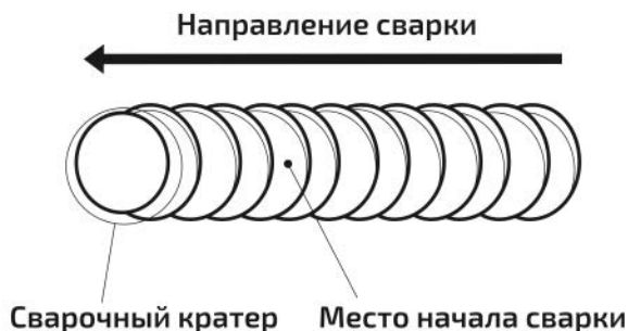
Рис. 11.1.2. Начало сварки при смене электрода.
