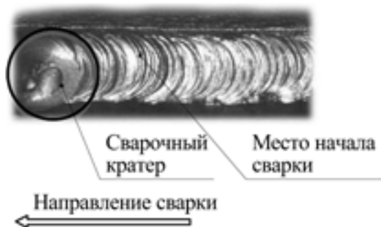
Рис. 7.5. Начало сварки при смене электрода.
